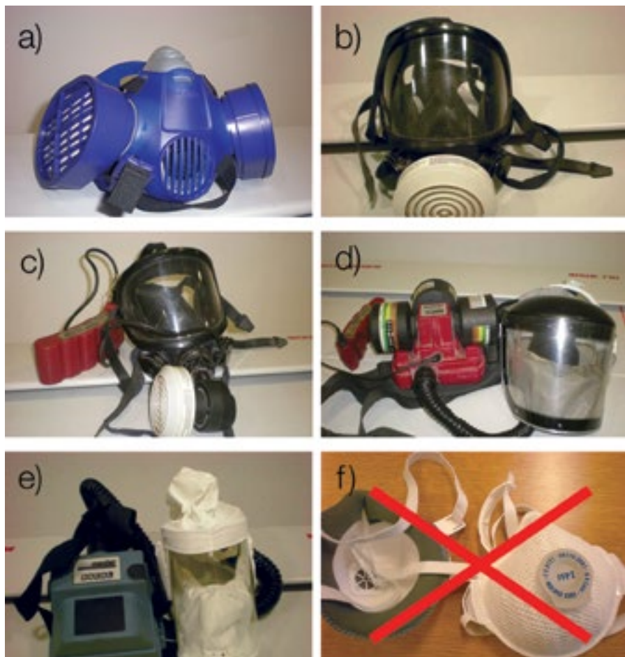
Slika 26: Osebna varovalna oprema za varovanje dihal : a) polmaska, b) obrazna maska, ki ustreza standardu EN 149 s filtrom P3, c) obrazna maska z ventrilom, d) obrazna maska z ventrilom, e) obrazna maska z ventrilom, f) respirator 27
