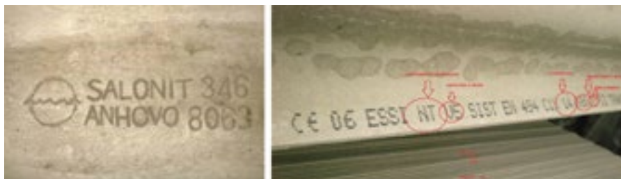
Slika 6: Oznaka valovite azbestcimentne strešne kritine, proizvedene v Salonitu, Anhovo (serija 346, dne 3.6.1980) in oznaka vlaknocementne plošče (NT - neazbestna tehnologija; V5 - plošča je 5 valna, proizvedena skladno s SIST EN standardom leta 2014, 80. dan v letu, ob 7:13 uri) proizvedena v Esalu, Anhovo 7
